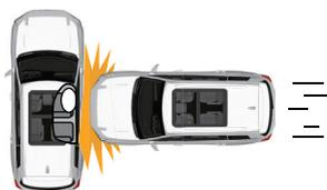
Боковые подушки и шторки безопасности могут сработать при сильном ударе в боковые части автомобиля.
