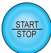
Когда рычаг переключения передач находится в положении Р, нажмите на педаль тормоза, и подсветка выключателя зажигания загорится зеленым цветом. Затем нажмите на выключатель зажигания, чтобы запустить двигатель.
