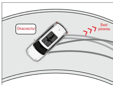
При блокировке задних колес может произойти занос задней оси, который в критических случаях может достигать 180°.
