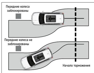
При блокировке передних колес автомобиль теряет способность поворачивать и может лишь скользить в направлении, заданном в начале торможения.
