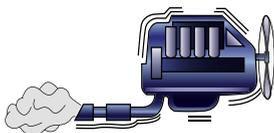
При использовании бензина с октановым числом ниже рекомендованного (использование бензина несоответствующей марки) может возникнуть детонационный стук в двигателе.
